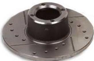
Le fait de percer les disques subit le même mal entendement que le fait de les rainurer. La raison est la même, à part que les trous sont plus efficaces avec le temps car ils sont plus ou moins auto-nettoyants. Le seul gros défaut, à part si on abuse sur le nombre de trous (encore la réduction de la surface de friction) est qu'un disque avec une masse insuffisante (diamètre trop petit ou trop fin) a tendance à craqueler et casser.
